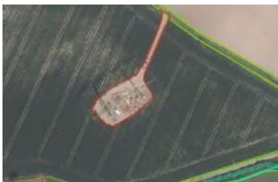
Surface aménagée incluant la zone d'implantation du pylône et un chemin d'accès
